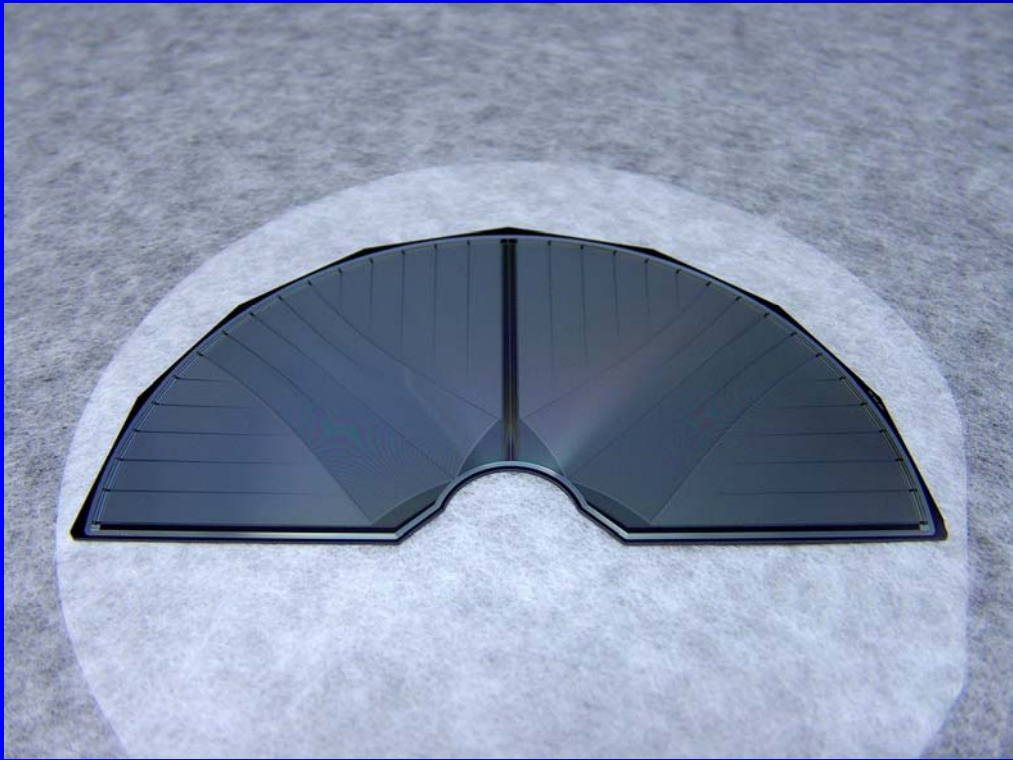
LHC-b R-300 um silicon chip.
