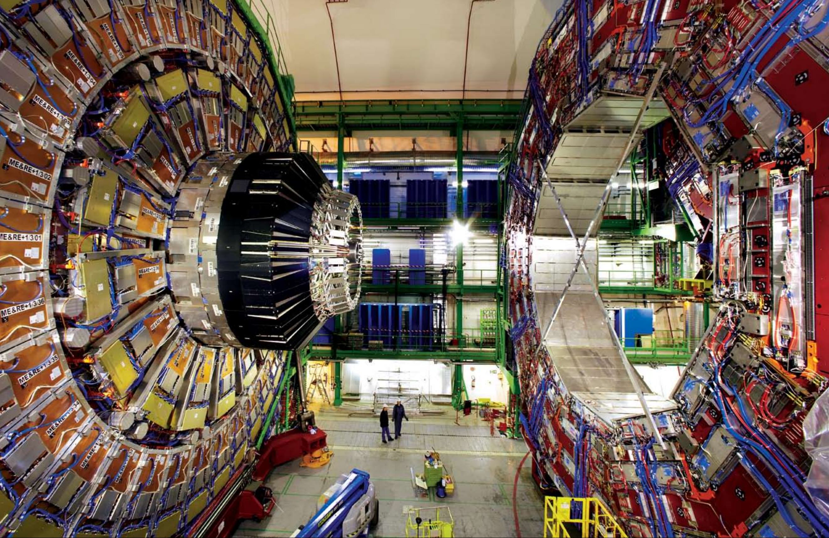
Der CMS-Detektor ist beinahe fertig. Seine Sensoren werden registrieren, was geschieht, wenn Atomkerne kollidieren. In den Daten könnte dann der Nachweis der flüchtigen Teilchen verborgen sein, nach denen die Physiker suchen.
